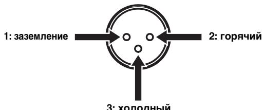
При выполнении подключения к устройству убедитесь, что контакты совпадают и вставьте гнездовую часть разъема на симметричном кабеле XLR до щелчка. Для отсоединения кабеля нажмите на рычажок на разъеме и вытяните разъем из гнезда.
