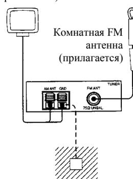
Заземление (разъем GND)
